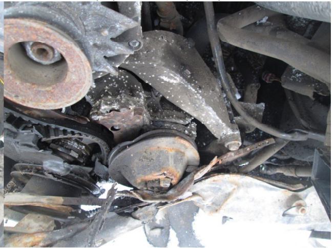
Шкив клинового ремня (водяного насоса), защита зубчатого ремня, шестерня зубчатого ремня (шкив промежуточного ремня)
